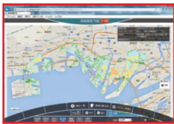
津波による浸水深想定を表示
